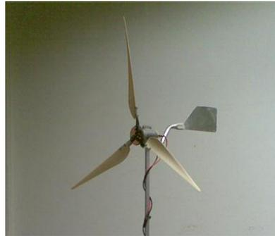
Fixação da estrutura do motor na barra de alumínio cilíndrica (torre).
